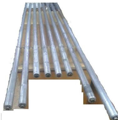
Зонд-инклинометр **Геопласт-35.50** со встроенным модулем гамма-каротажа предназначен для применения в беспроводных забойных телесистемах наклонного и горизонтального бурения с электрическим каналом. Инклинометр может использоваться в MWD, LWD системах, при геофизических исследованиях вертикальных, наклонных, наклонно-горизонтальных, горизонтальных, обсаженных, необсаженных скважин, при вырезке колонны, установке клиньев, бурении боковых стволов.
