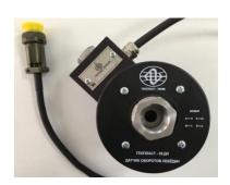
Датчик оборотов вала буровой лебедки «Геопласт-35.ДЛ» предназначен для определения глубины положения бурового инструмента в скважине. Используется с наземным оборудованием «Геопласт».
